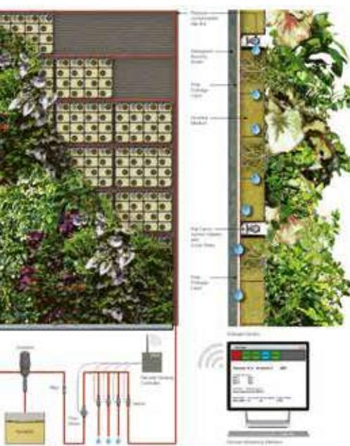
↑ Systém zavlažování zelené stěny Regal House od firmy Biotecture.
